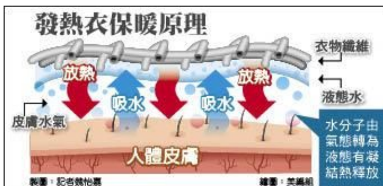
圖(十七) 發熱衣的吸濕發熱原理 (圖片來源：自由時報；製圖：記者魏怡嘉；繪圖：美編組)。
